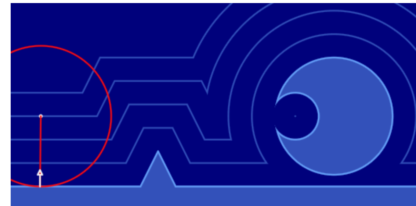
Sphere Tracing (feltételezi, hogy a derivált korlátos, pl. SDF)
